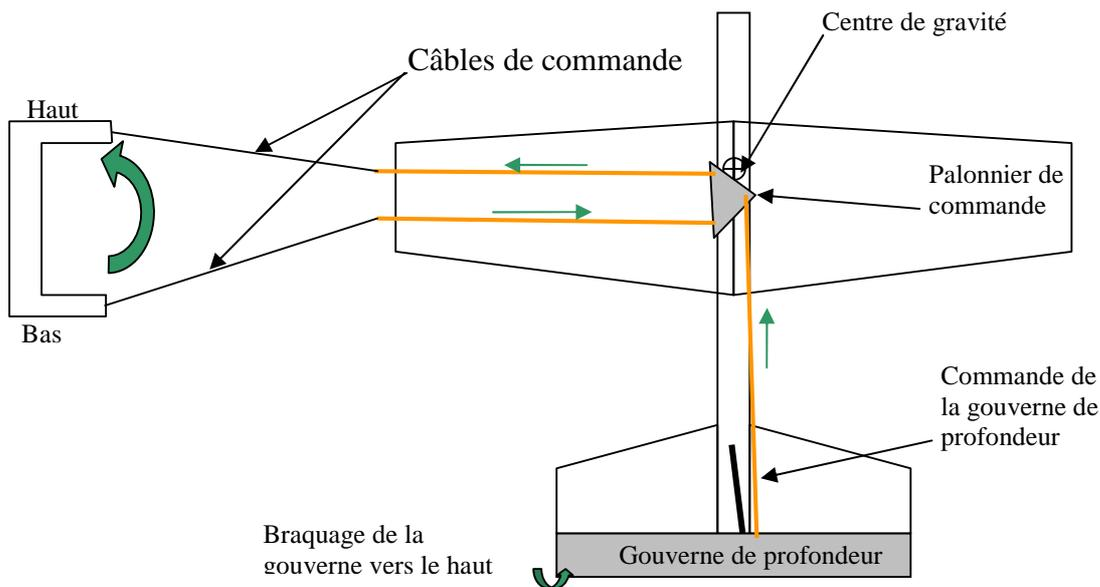
Lorsque le pilote imprime un mouvement de rotation vers le haut à la poignée, il tend le câble supérieur qui entraîne un mouvement de rotation du palonnier et fait débattre la gouverne pour faire monter le modèle. Un mouvement inverse produit le débattement inverse de la gouverne et fait descendre le modèle.
