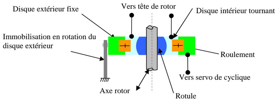
Lorsque le plateau cyclique est horizontal, si l'on considère les biellettes en liaison avec la tête de rotor, celles-ci ne se déplacent pas verticalement. Aucune action n'est transmise à la tête de rotor.
