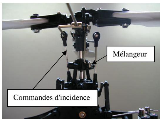
Un mélangeur mécanique relie chaque côté de la barre de Bell à une pale du rotor principal.
