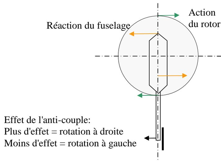
Puisqu'il existe un couple qui fait pivoter l'hélicoptère autour de son axe de lacet, il suffit de diminuer ou d'augmenter la force anti-couple pour laisser le fuselage s'orienter vers un côté ou le forcer à s'orienter de l'autre. Pour modifier cette force, un dispositif assure une variation de calage des pales du rotor anti-couple. C'est le gouverne de direction de l'hélicoptère.
