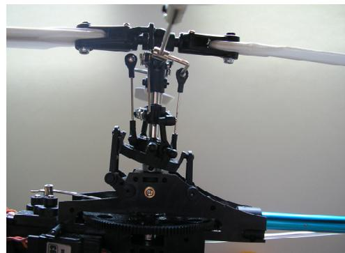
Le plateau cyclique joue le rôle de la commande d'ailerons et de la commande profondeur.
